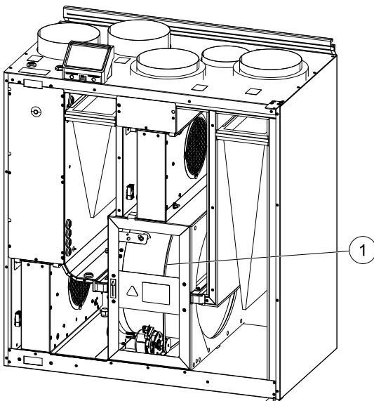
Рис. 12 Приводной ремень ротора
