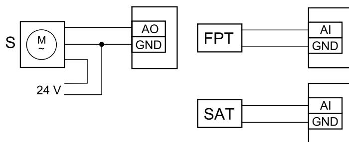
Рис. 17 Соединения водонагревателя
