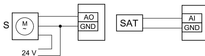
Рис. 18 Соединения канального охладителя
