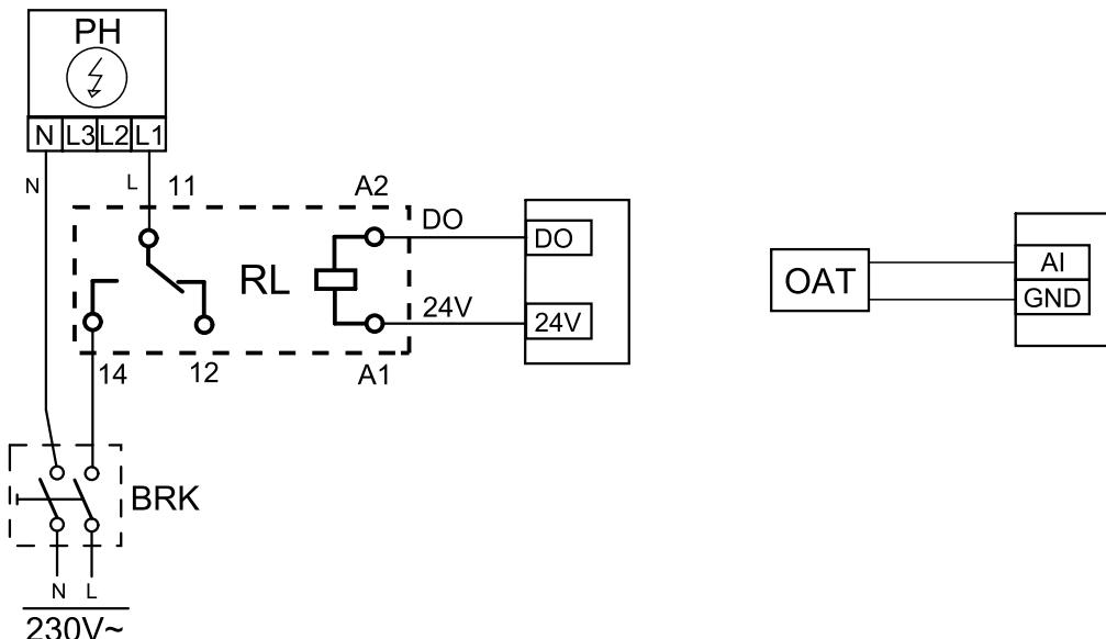
Рис. 15 Соединения предварительного нагревателя
