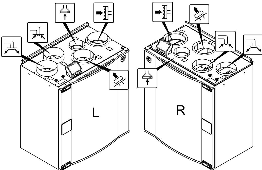
Рис. 3 Соединения воздуховодов
