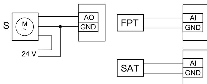
Рис. 16 Соединения водонагревателя
