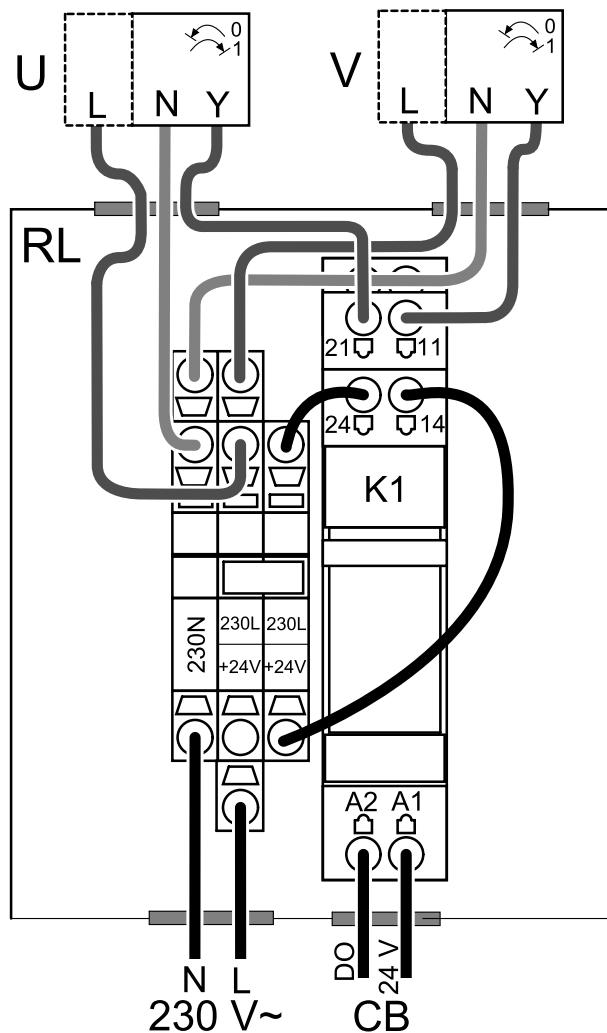
Рис. 20 Подключение клапана
