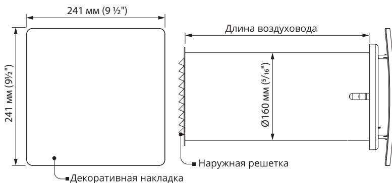
Длина воздуховода и модель внутренней решетки зависит от модели установки, см. «Структура условного обозначения».
