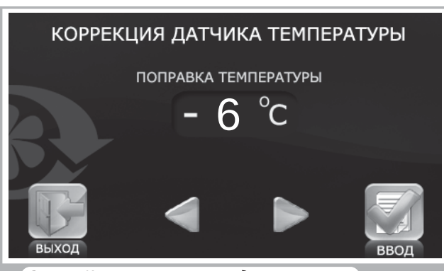
Рис. 28. Коррекция настроек датчика температуры
