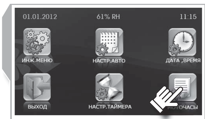
Рис. 37. Переход в настройки моточасов
