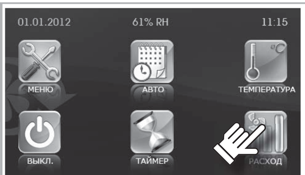
Рис. 8. Переключение скорости вентиляторов
